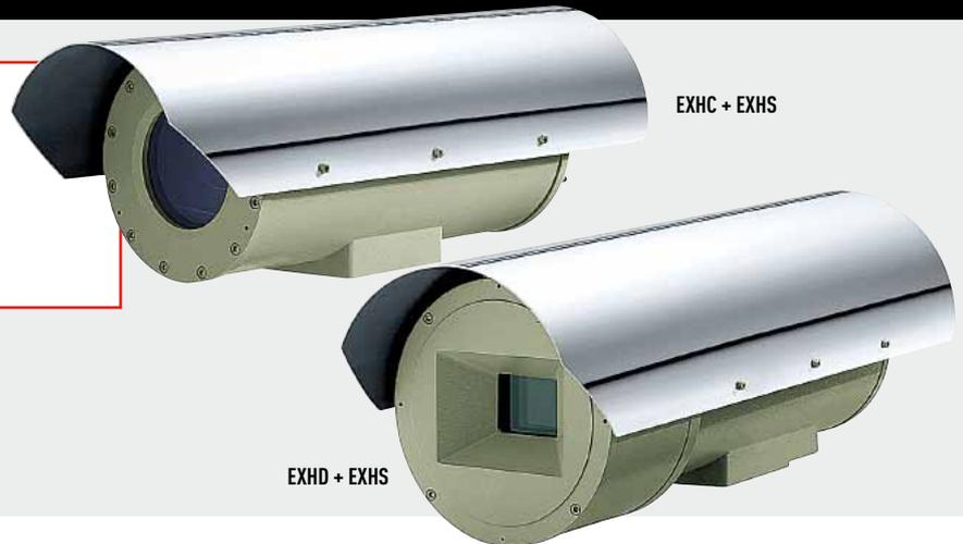
Die Gehäuse EXH bestehen aus einer massiven Aluminiumgußlegierung Anticorodal der Gruppe AlSi Mg EN – 42000. Je nach Modell werden sämtliche Elemente im Ofen mit Pulver mit besonderen Überzügen beschichtet, die äußerst beständig gegen ultraviolette Strahlungen, Salznebel und Luftschadstoffe sind (mod.003R, mod.005R). Sie werden nach den Vorgaben der Richtlinie 94/9/CE ATEX, der Protokolle IEC 60079-0:2000, IEC 60079-1:2001, IEC 61241-0:2004, sowie IEC 61241-1:2004 hergestellt und GOST-R.
